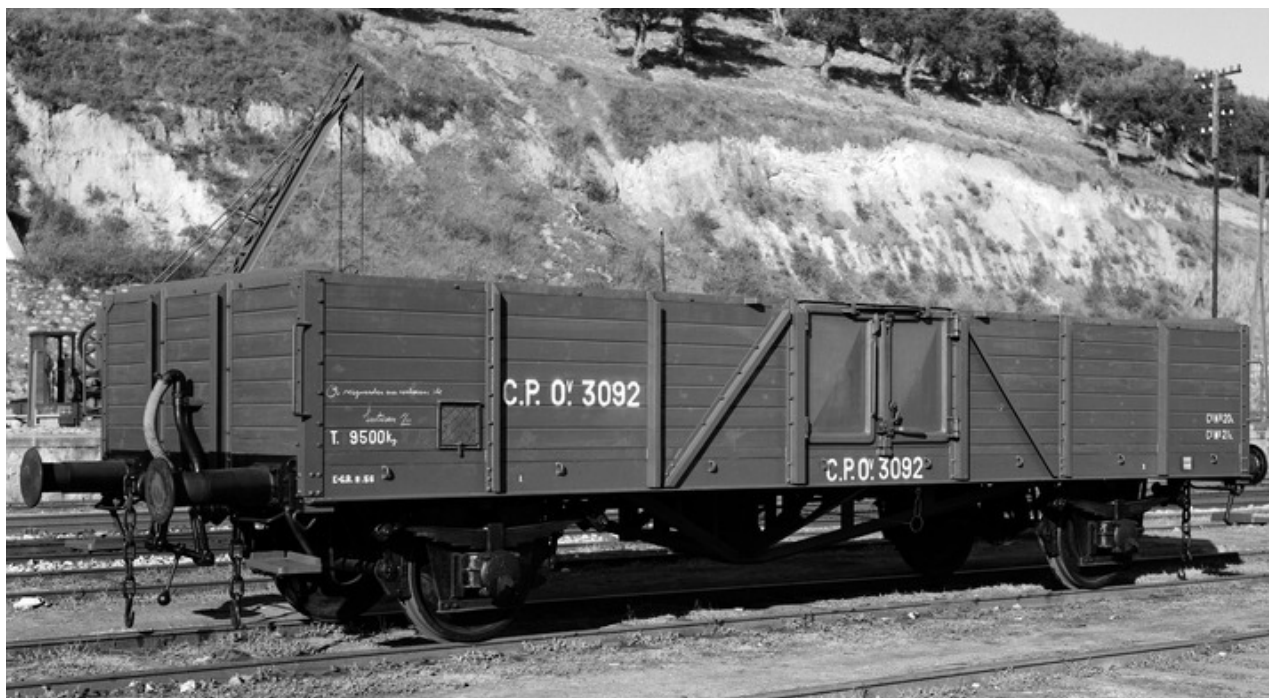
Vagón abierto de construcción alemana matriculado en los ferrocarriles portugueses. Unidades casi idénticas circularon por las vías españolas. Foto Mário Novais, Fondo Calouste-Gulbenkian
