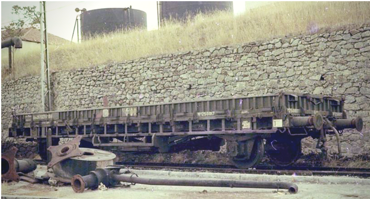
Plataforma Miv 250017, construida en 1942 en Alemania. Como indica su numeración, no dispone de freno de vacío, sino de tubería de paso. Manuel Gonzalez Marquez, Segovia, 1974
