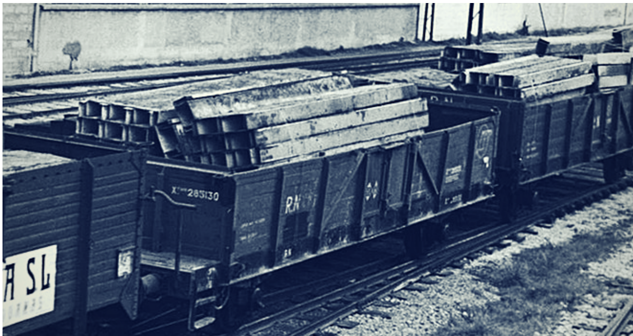
Vagón de bordes Xfh 285130, del tipo 'Linz'. Imagen procedente del documental 'Grandes Transportes', filmado en 1958. Foto cortesía ADIF / Filmoteca Española
